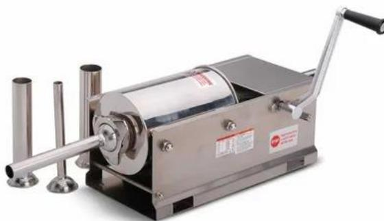
Рис. 14 Шприц для наполнения оболочки фаршем
