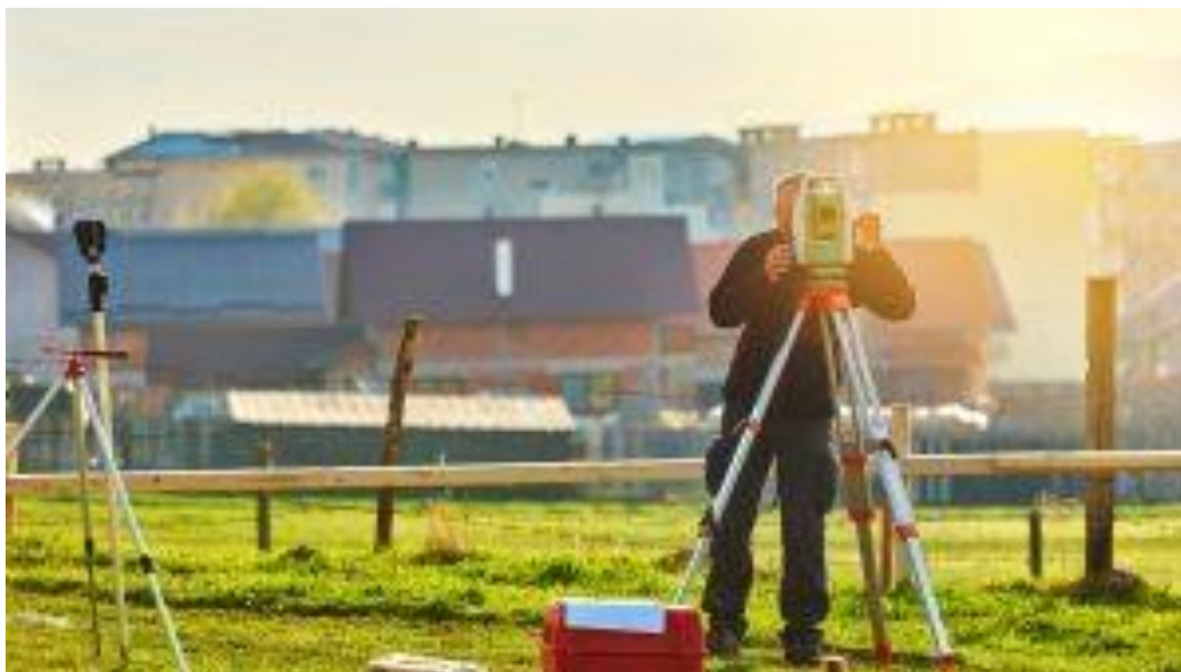
Рисунок 21. Измерение фактических границ земельного участка Измерения были осуществлены тахеометром Nikon NPL-362
