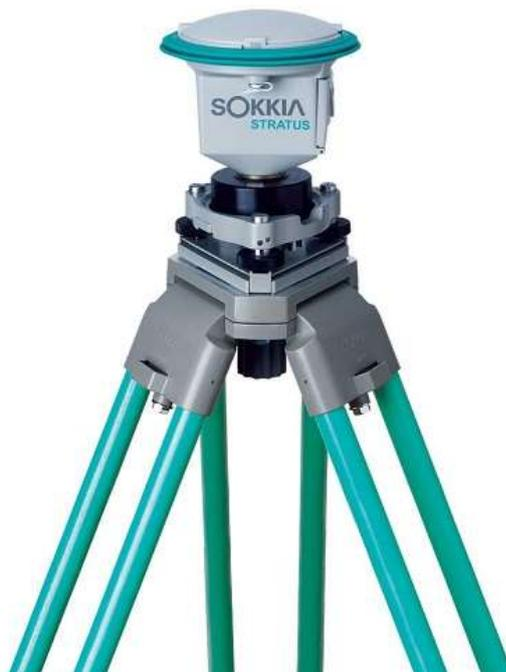
Рисунок 12. ГНСС-приёмник Sokkia Stratus
