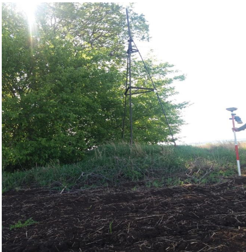
Фото 2-Координирование на пункте ГГС (привязка к местности).
