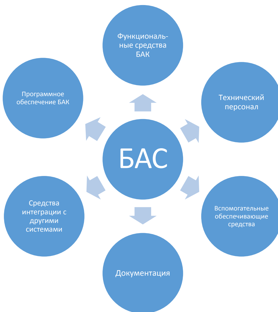
Рисунок 22. Структура беспилотных авиационных систем
