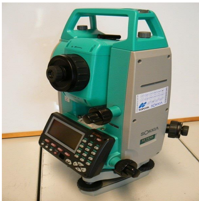
Рисунок 6. Электронный тахеометр Sokkia 610 №023878
