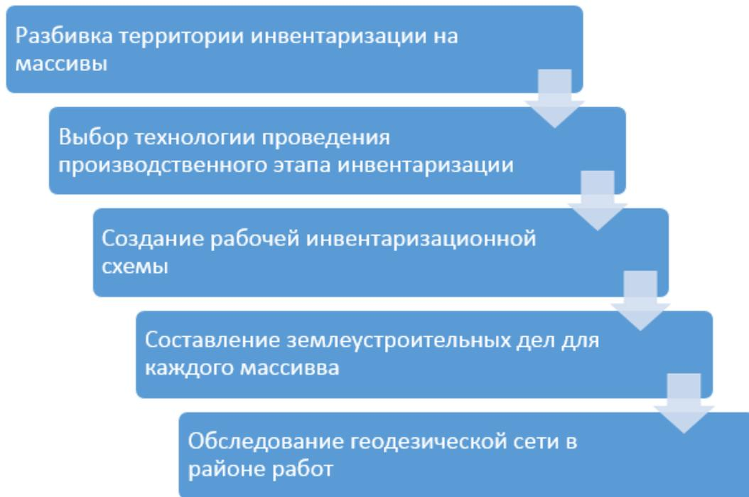
Рисунок 1. Порядок проведения работ в техзадании
