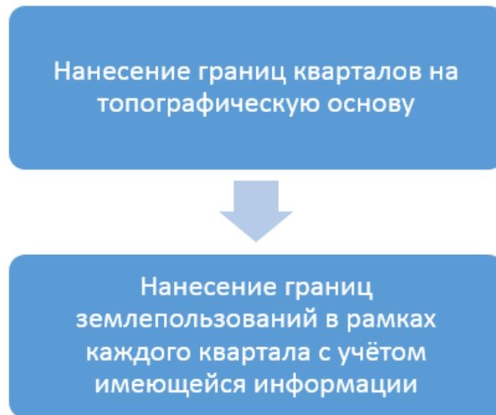
Рисунок 2. Составление рабочего плана инвентаризации на основе топографического материала
