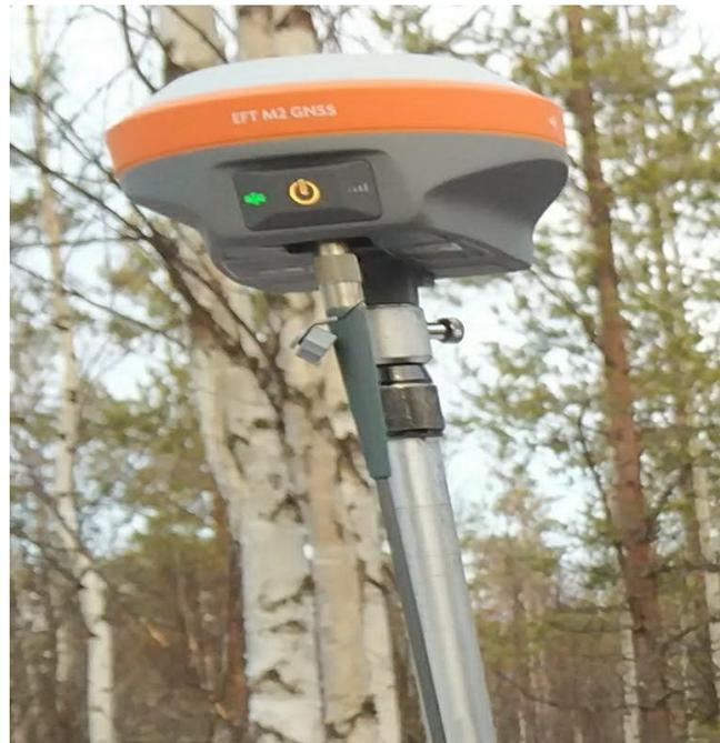
Рисунок 14. GNSS-приёмник EFTM2 GPS
