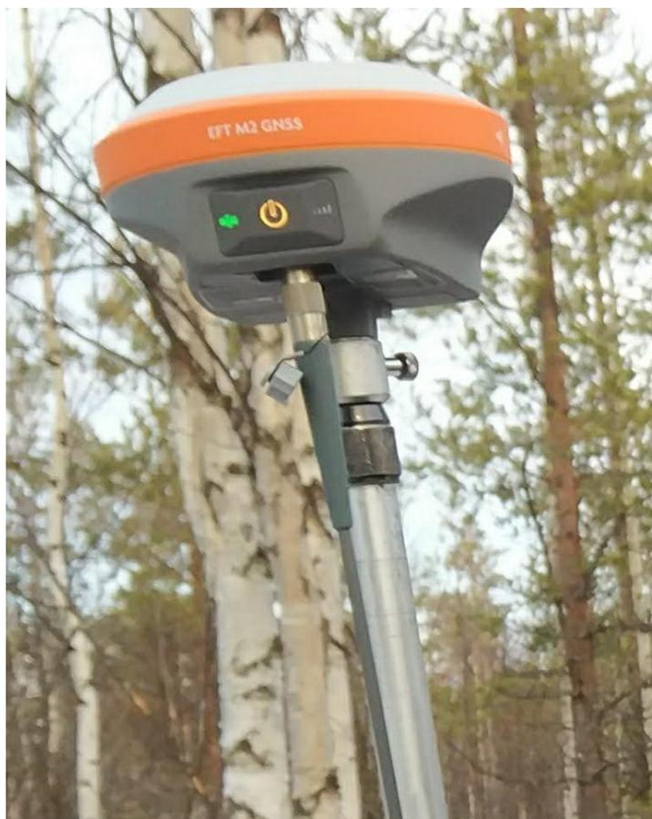
. ГНСС-приёмник EFTM2 GPS
