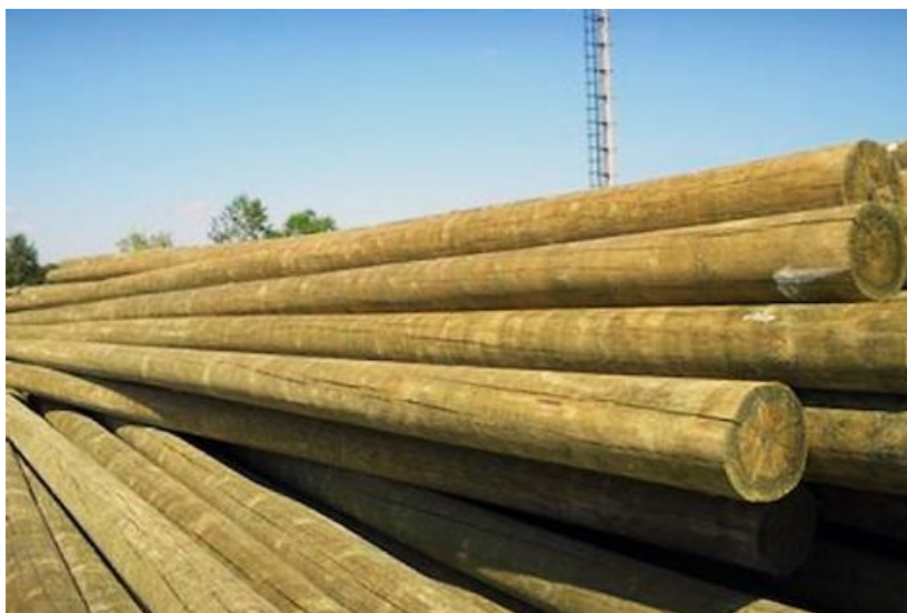
Рисунок 17 - Высушенные столбы для ВЛ
