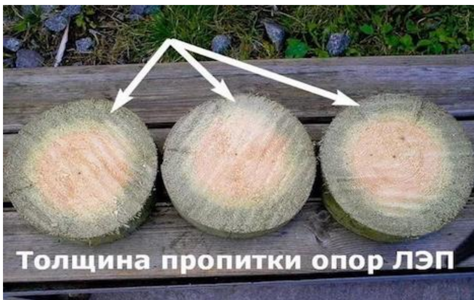
Рисунок 18 - Толщина пропитки опор линии электропередач
