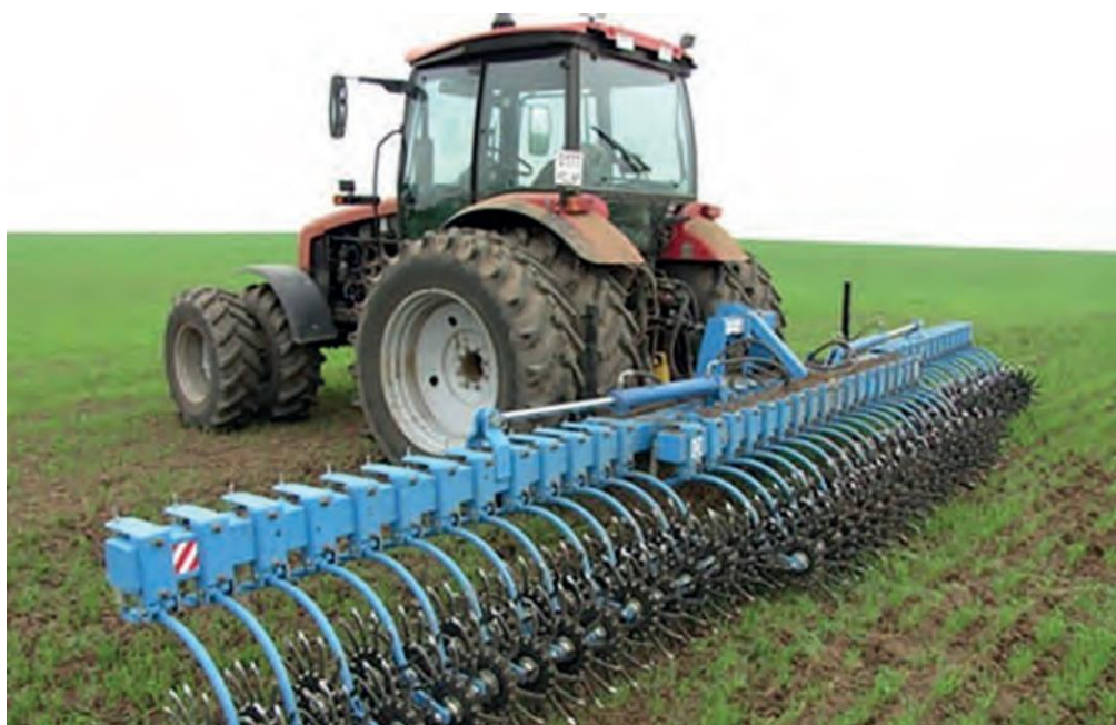
Рисунок 9. Боронование посевов (ротационная мотыга)
