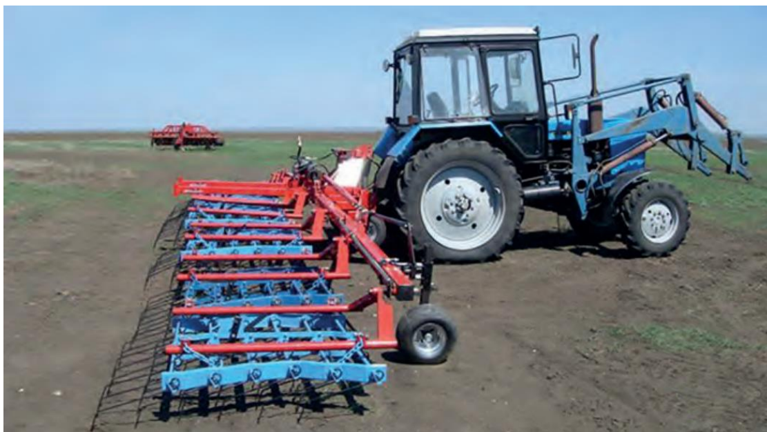
Рисунок 8. Слепое боронование с помощью пружинных борон
