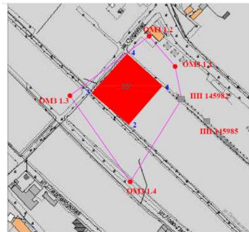
Рис. 2 Схема размещения пунктов ОМС
