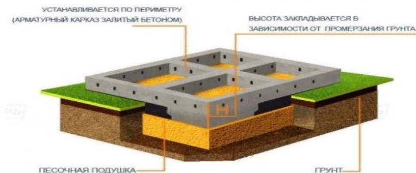
Рисунок 9. Ленточный фундамент
