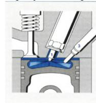
1. непосредственного впрыска топлива в неразделенную камеру сгорания.
