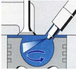
1. непосредственного впрыска топлива в неразделенную камеру сгорания.
