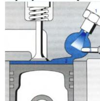
1. непосредственного впрыска топлива в неразделенную камеру сгорания.
