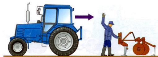
55. Можно ли гусеничной самоходной машиной сдвигать назад опущенную навесную машину?
