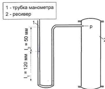
Рисунок 1.2 – Схема ресивера и манометра
