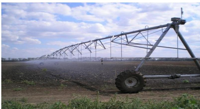
Рис. 15 Дождевальная машина «Фрегат»
