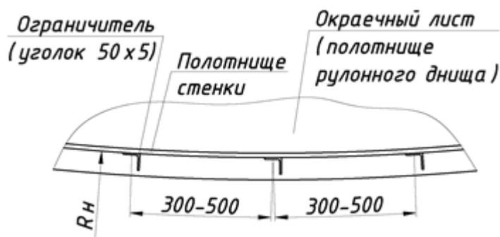
Рисунок 13 – Приварка ограничительных уголков
