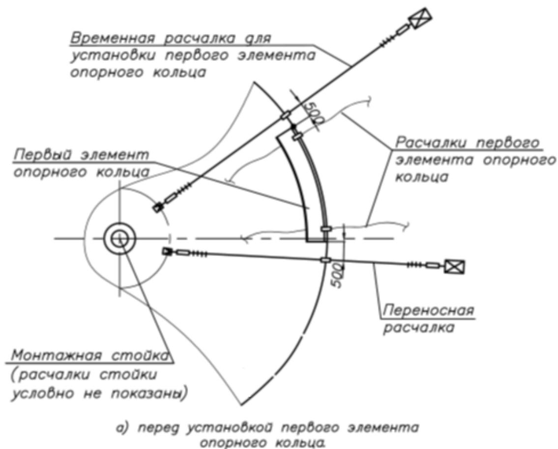
Рисунок 18– Монтаж опорного кольца
