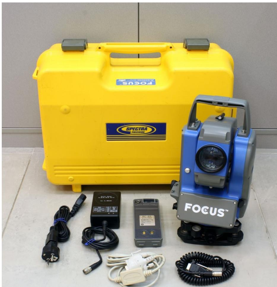
Фото 1. Электронный тахеометр Spectra Precision Focus™ 4
