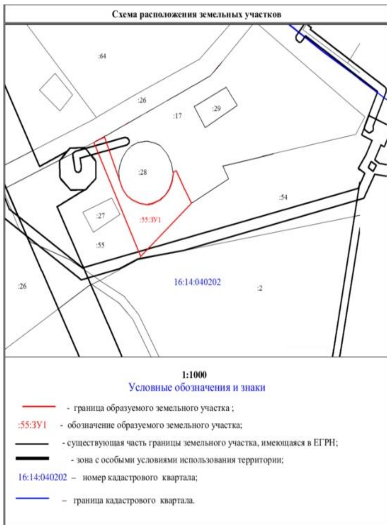
Рисунок 10. Схема расположения земельных участков при разделе земельного участка с КН 16:14:000000:55
