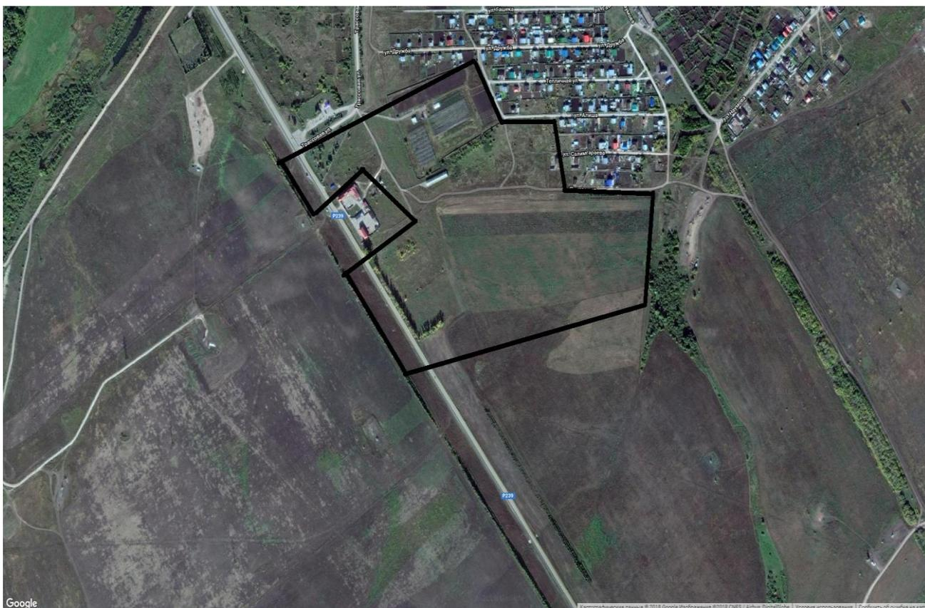
Рисунок 3 – Планировка территории для строительства ЛЭП
