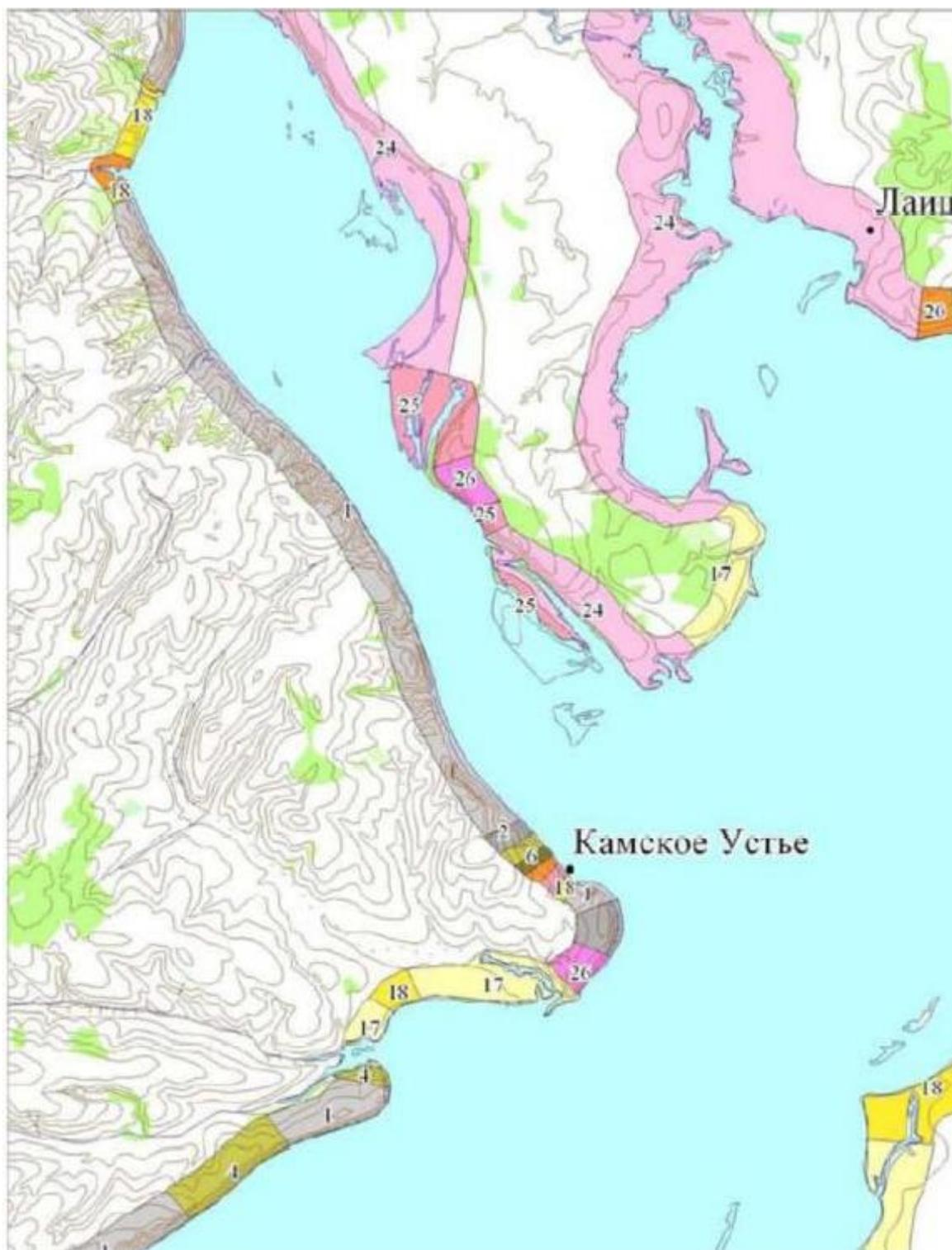
Рис.1 Карта предварительного инженерно-геологического районирования побережья Куйбышевского водохранилища в Камско-Устьинском муниципальном районе по условиям его переформирования (фрагмент).
