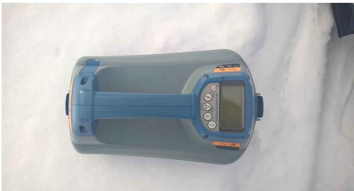
Фото 6. Генератор Radiodetection TX-5
