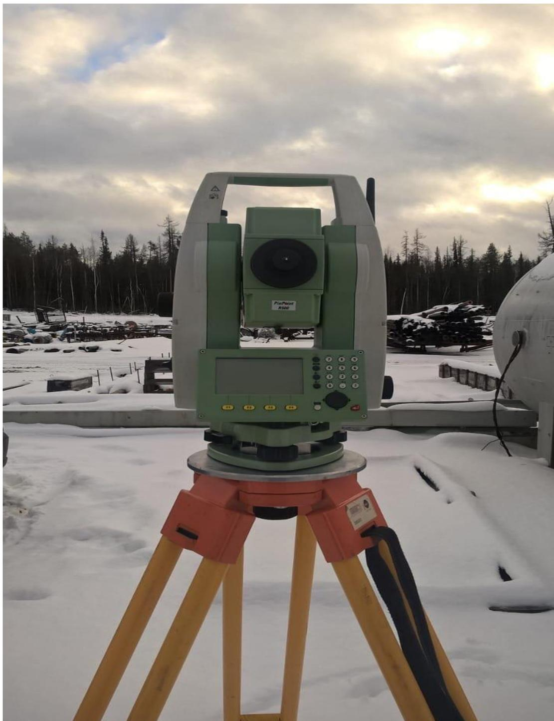
Фото 2. Тахеометр Leica TS06plus R500 Arctic 5
