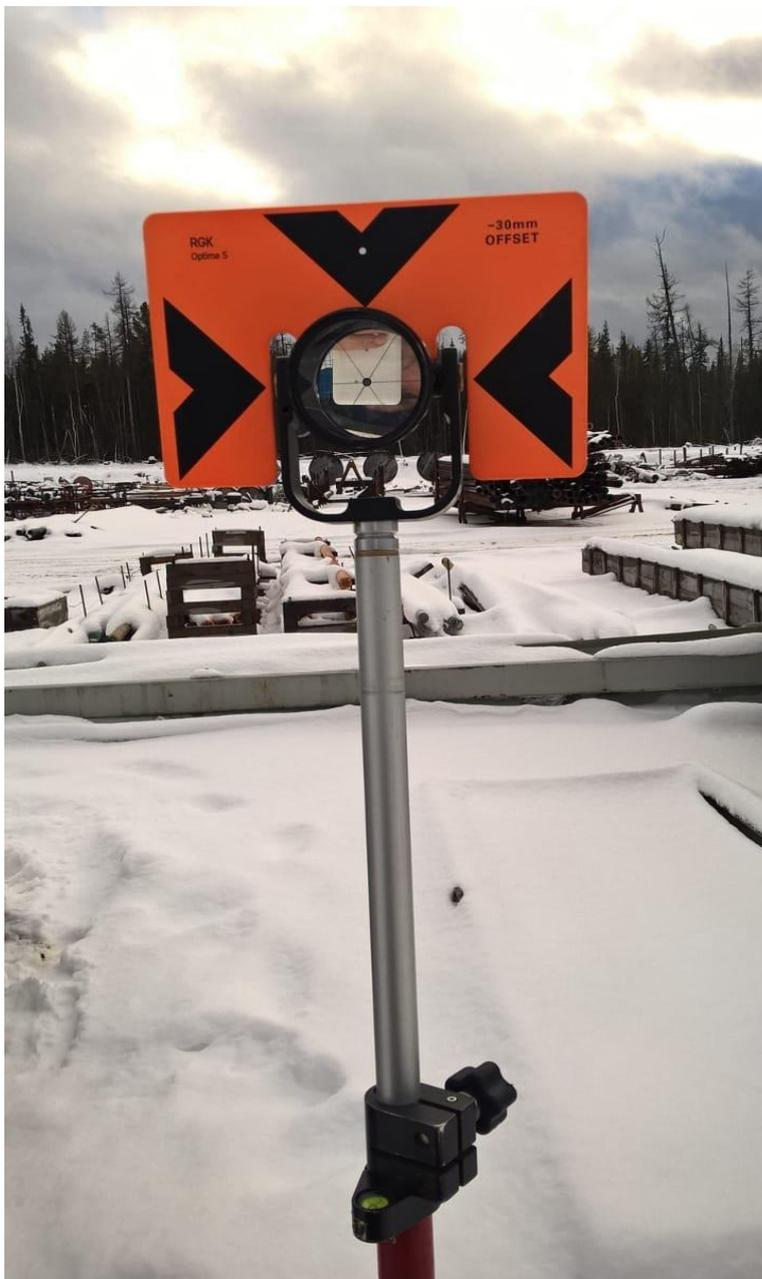
Фото 4. Веха телескопическая и отражатель
