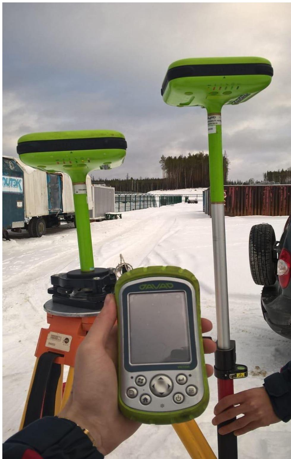
Фото 3. GPS-приёмник JAVAD Triumph-1M и контроллер JAVAD Victor
