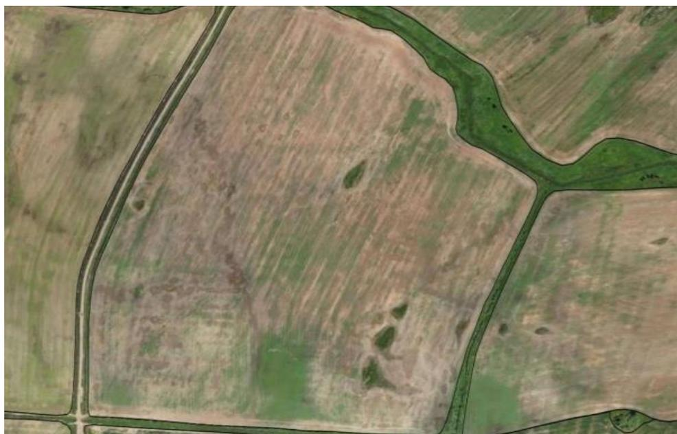
Рис. 8. Фрагмент аэрофотоснимка неработающей закрытой дренажной системы
