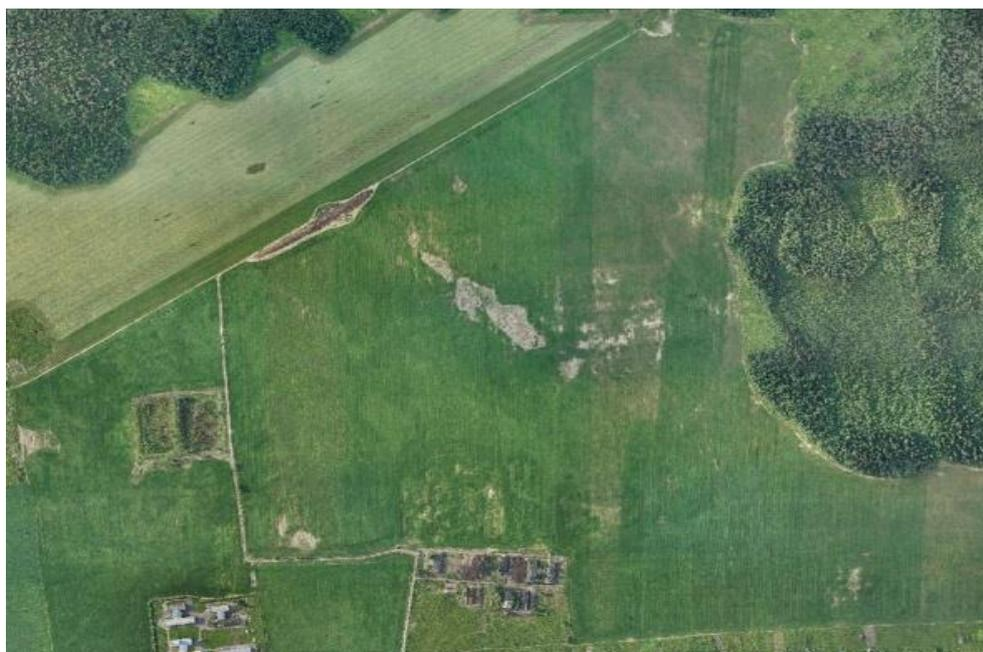
Рис. 7. Фрагмент аэрофотоснимка с неисправной мелиоративной системой.
