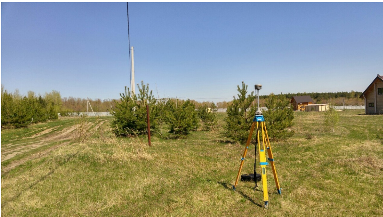
Фото 2. GNSS приемник SOUTH Galaxy G1 при съемке земельных участков в СНТ «Луч»
