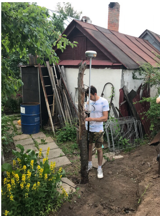
Фото 1. GNSS приемник South S82-T. Работа геодезиста при выносе точек границ в натуру
