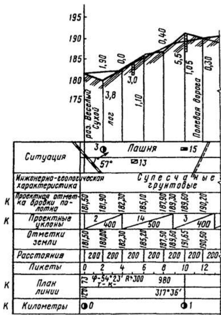
Рисунок 6. Продольный профиль участка трассы
