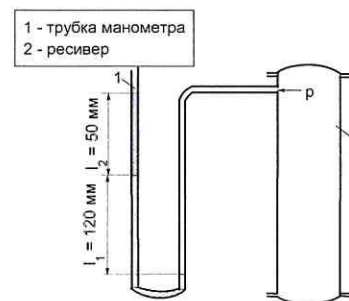
Рисунок 1.2 – Схема ресивера и манометра
