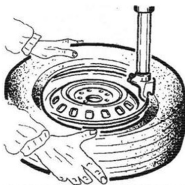
Рисунок 1.3 - Монтаж покрышки на обод колеса (забортовка)
