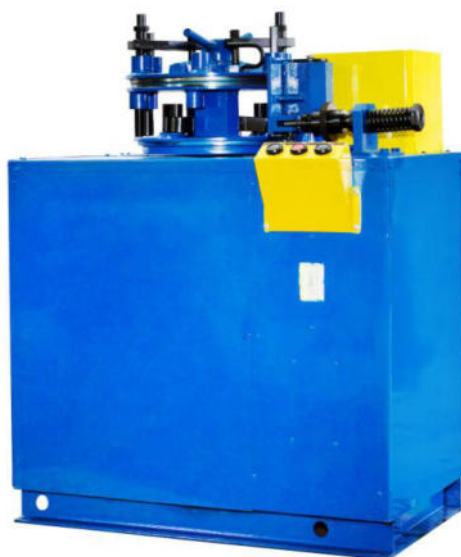
Рисунок 1.5 - Стенд для клепки и срезания тормозных накладок автомобиля
