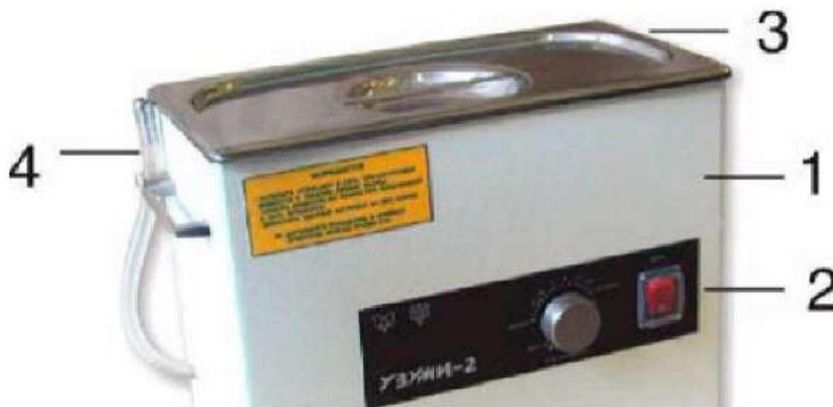
Рисунок 1.3 – Установка ультразвуковой мойки. 1 - корпус; 2 - таймер; 3 - крышка ванны; 4 - сливной шланг.
