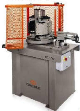
Рисунок 1.4 - Стенд для клепки и срезания тормозных накладок автомобиля БЕЛАЗ
