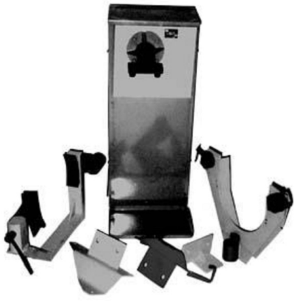
Рисунок 3.1 – Стенд универсальный для разборки двигателей легковых автомобилей и редукторов ведущих мостов автомобилей ЗИЛ и КамАЗ и его сменные станины
