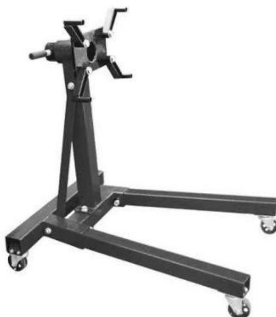
Рисунок 1.6– Кантователь AE&T T63005.
