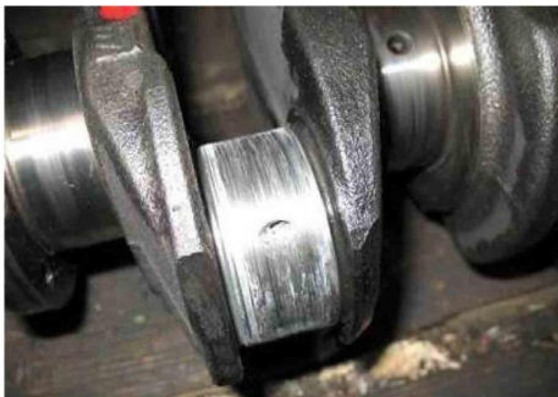
Рисунок 1.4 - Царапины на коленчатом вале.
