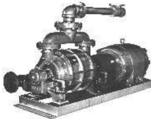
Рисунок 1.6- Вакуумный насос LHG 14 «Wedag» с ПЭ
