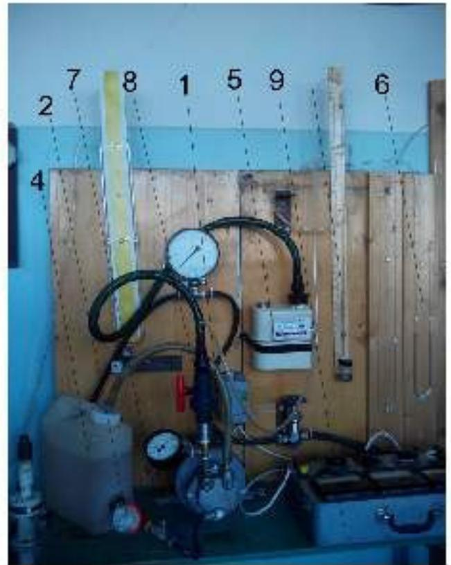
1 - водокольцевой вакуумный насос; 2 - счетчик расхода воды; 3 - цифровой инфракрасный термометр HT-822; 4 - водосборник; 5 - счетчик расхода воздуха; 6 - манометр на входе в вакуумный насос; 7 - вентиль для регулирования подачи воды; 8 - вентиль регулирования воздуха; 9 - измерительный комплект К-50; 10 - метеостанция Ea2 BL508
