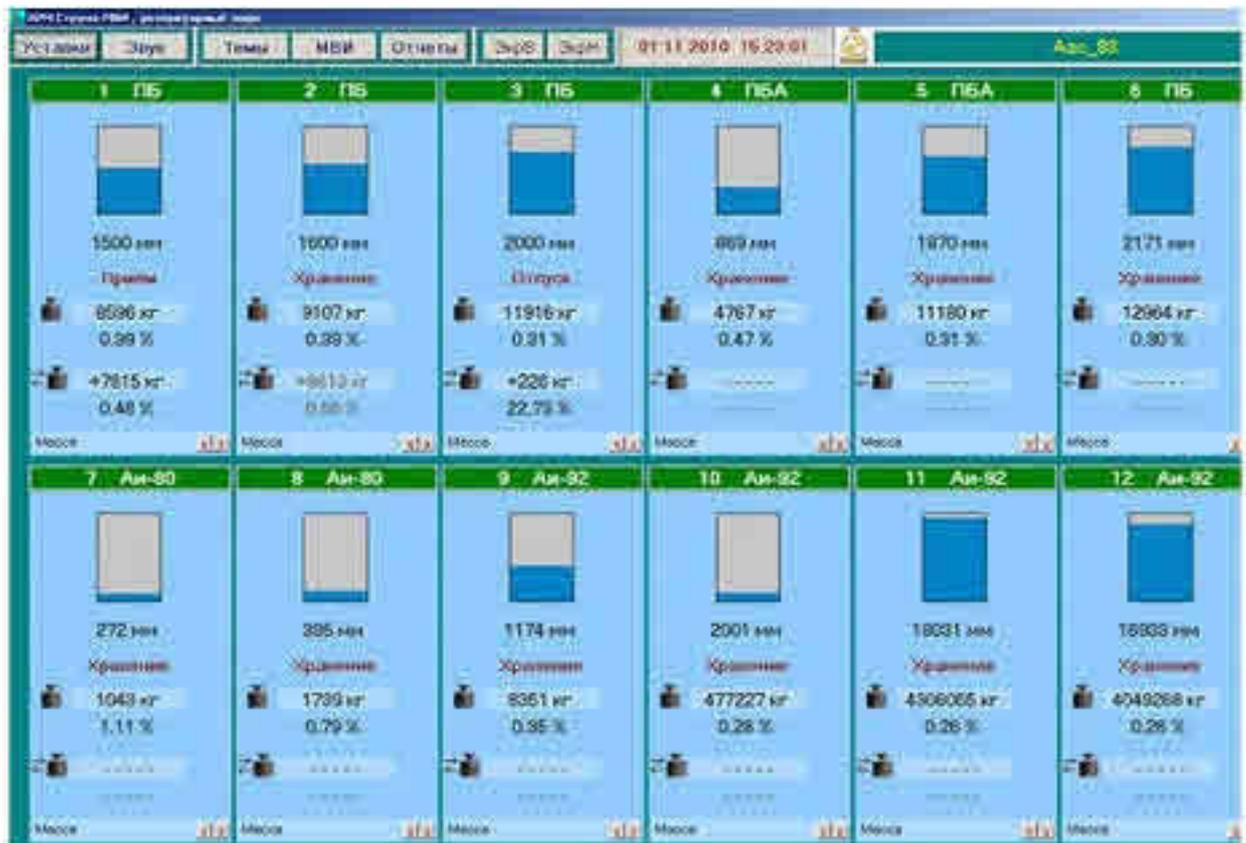
Рисунок 2.6 – Вид на мониторе рекомендации по массе и по уровню взлива в резервуаре
