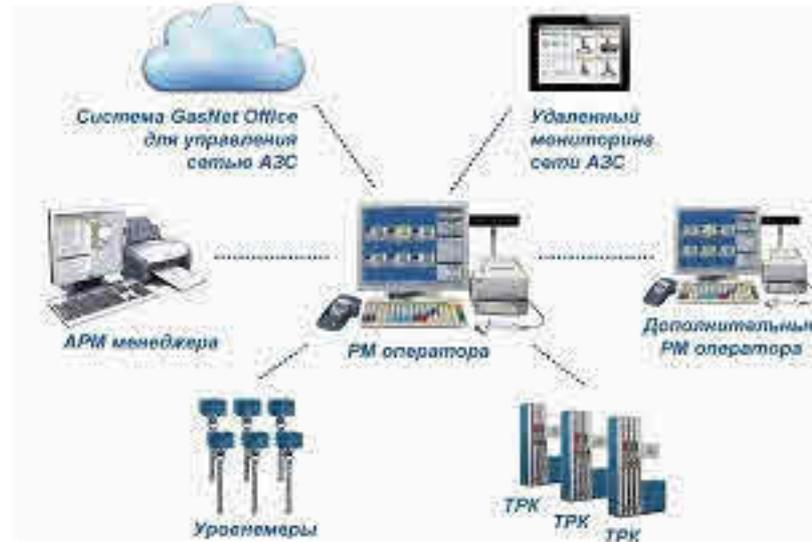
Рисунок 3.1 – Функционирование программы "Менеджер АЗС".
