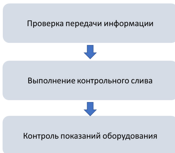
Рисунок 6 - Схема проверки работоспособности оборудования в комплексе
