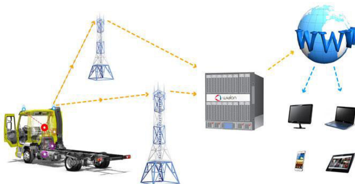
Рисунок 1 - Схема работы программного комплекса «WIALON»
