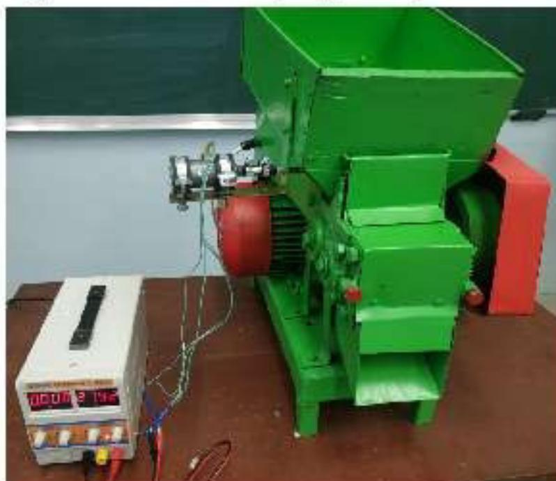
Рисунок 3.2. - Общий вид малогабаритной плющилки зерна
