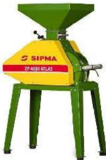
Рисунок 1.7 – Зерноплющилка Sipma «Atlas»
