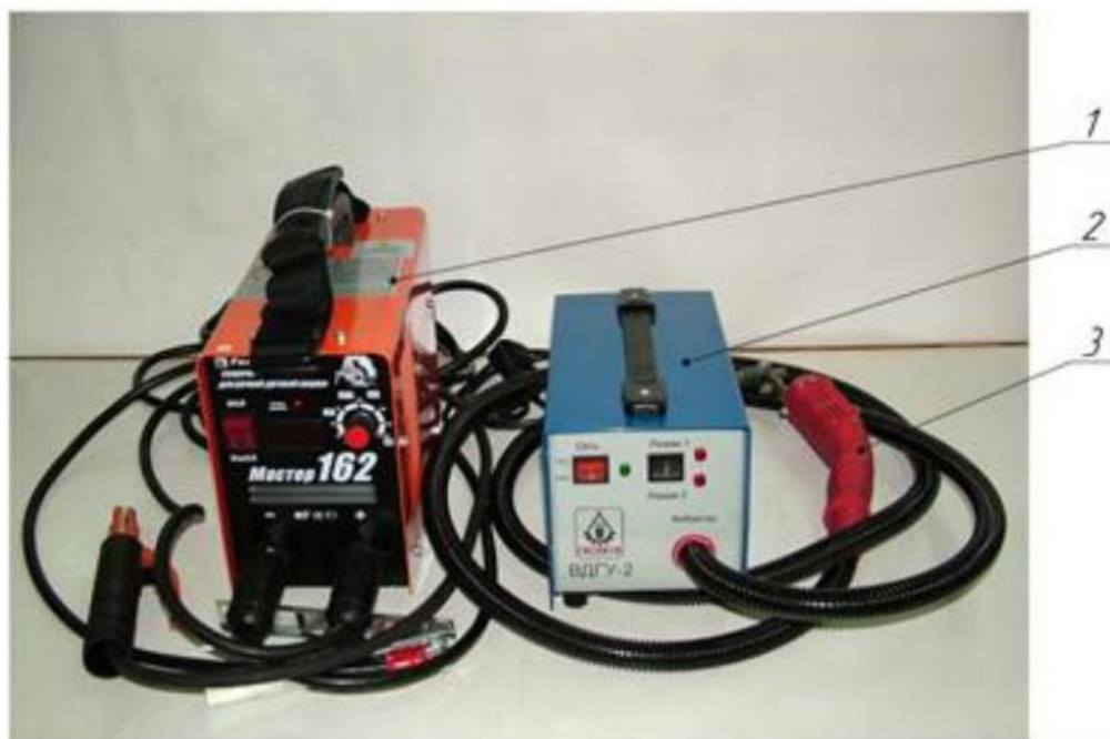
1 – сварочный инвертор (источник тока); 2 – пульт управления; 3 – вибратор
