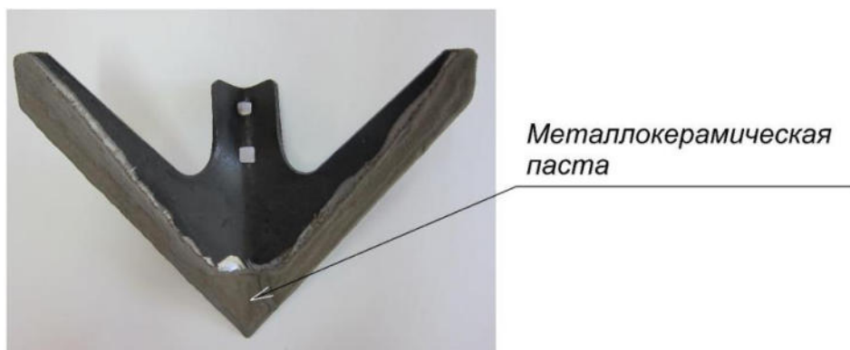
Рисунок 5.2 – Стрельчатая лапа культиватора КШУ-8 с нанесенной и высушенной металлокерамической пастой на режущей кромке
