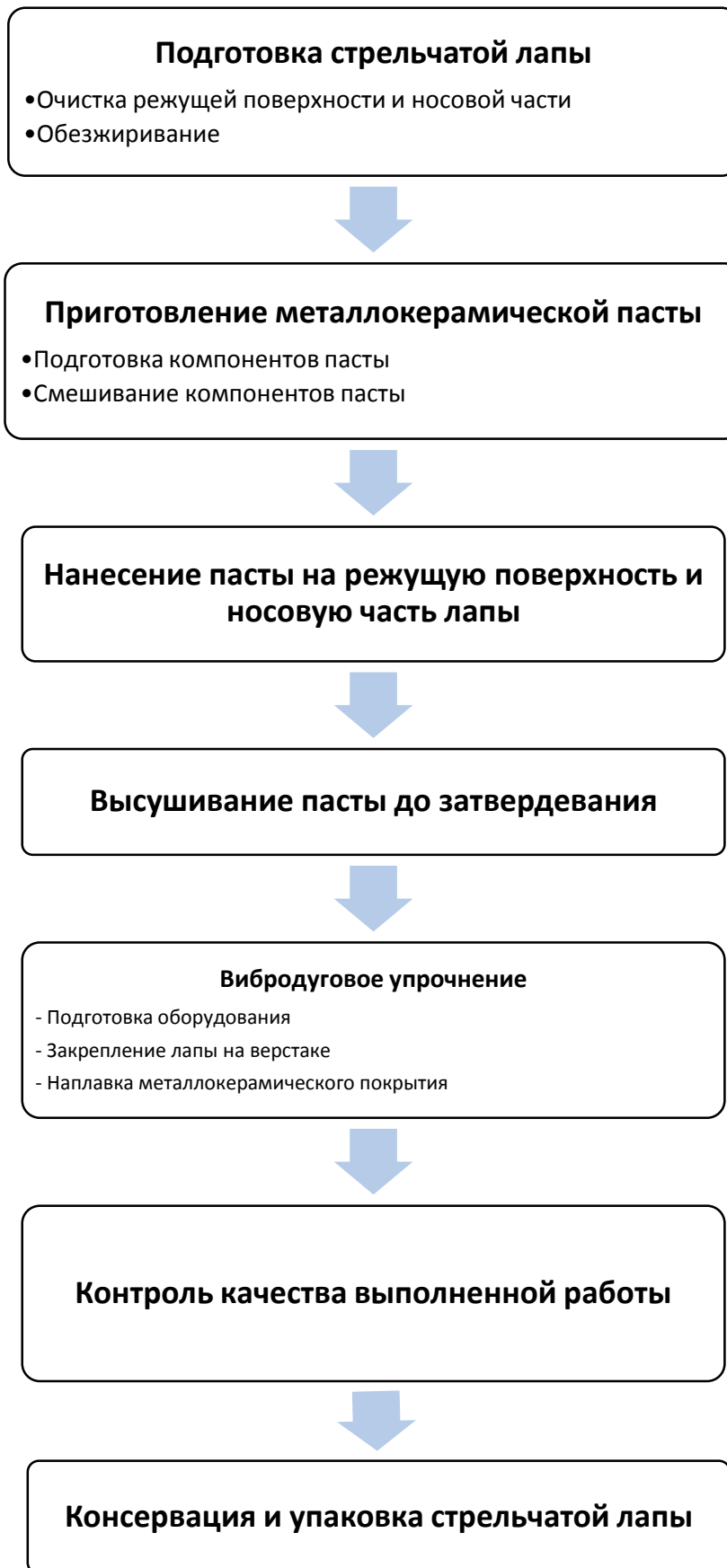
Рисунок 5.1 - Схема технологического процесса вибродугового упрочнения стрелчатых лап почвообрабатывающих
