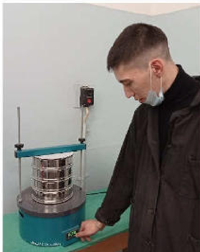
Рисунок 3.5 – Определение модуля помола с помощью ситового анализатора А20
