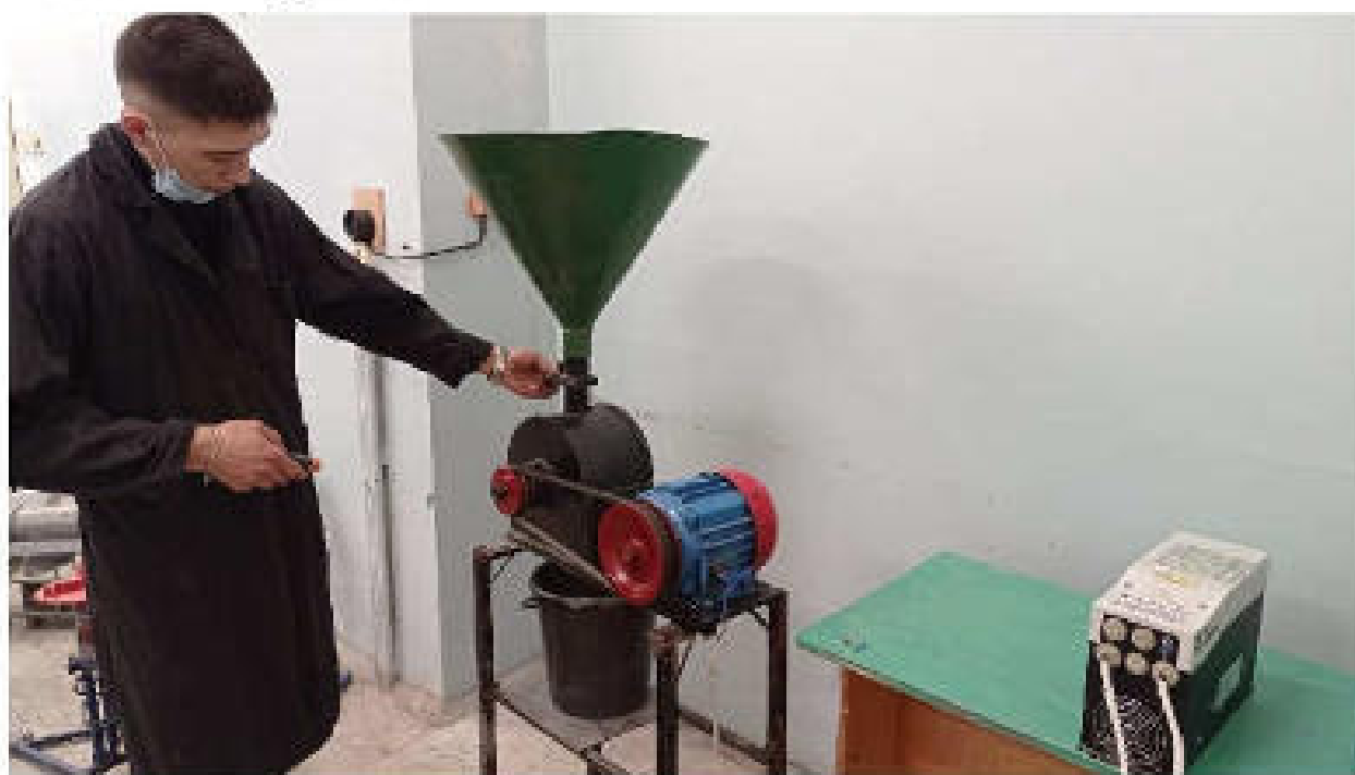
Рисунок 4.1 – Проведение экспериментов на лабораторной молотковой дробилке
