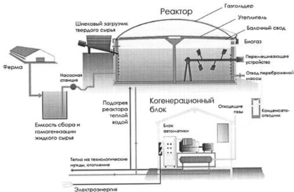
Рисунок 1.1 – Получение и использование биогаза.
