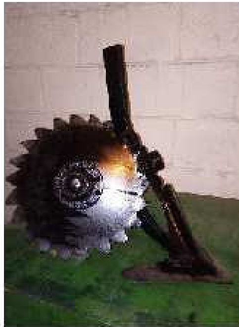
Рисунок 2.3 – Общий вид рабочего органа окучника
