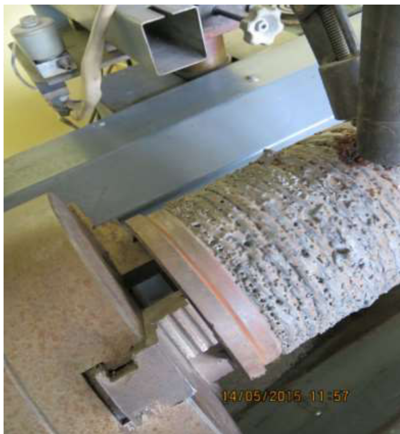
Рисунок 3.9 – Процесс наплавки гильзы под флюсом.
