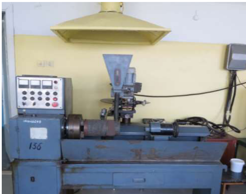
Рисунок 3.7 – Наплавочная установка УД - 209.
