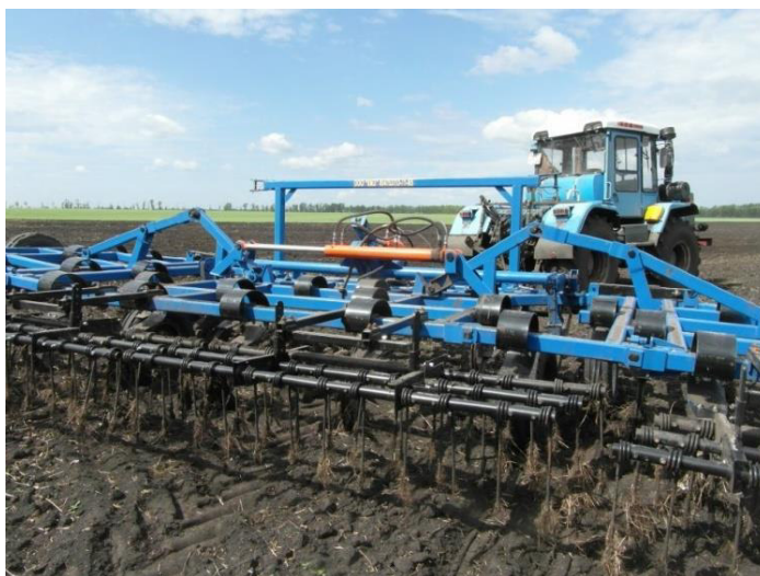
Рисунок 3.6 – Почвообрабатывающий агрегат в составе трактора ХТЗ-17221 и культиватора КШУ-8
