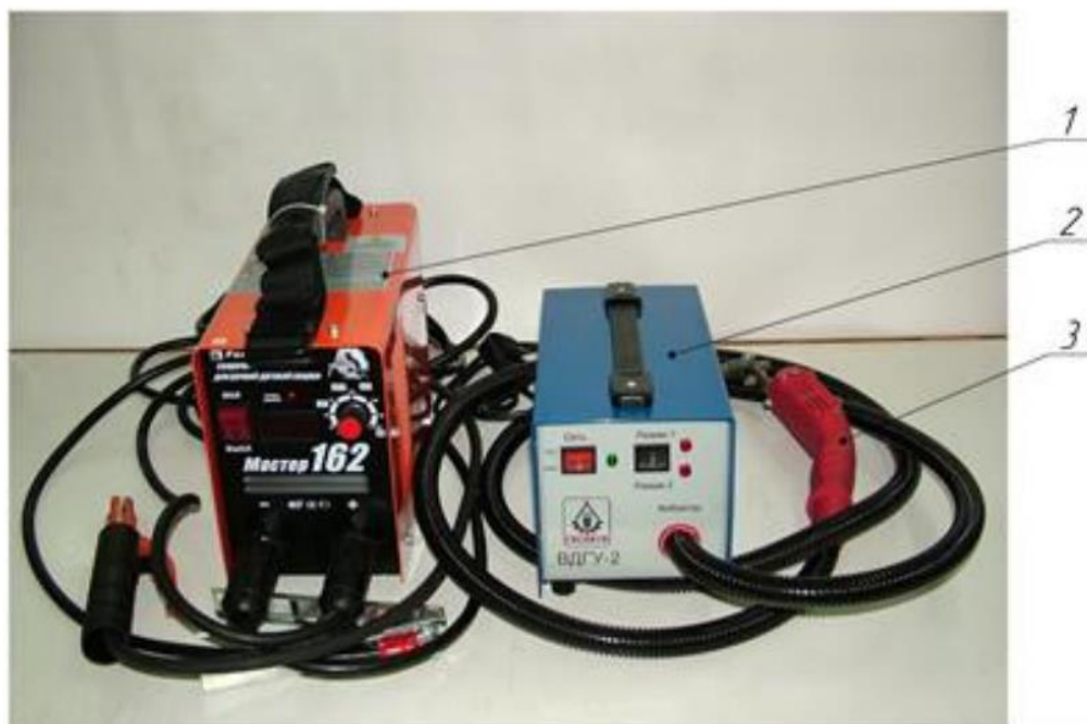
1 – сварочный инвертор (источник тока); 2 – пульт управления; 3 – вибратор
