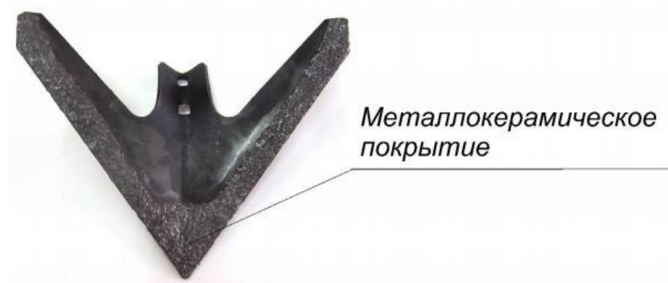
Рисунок 5.3 – Стрелчатая лапа, упрочненная с использованием разработанной технологии
