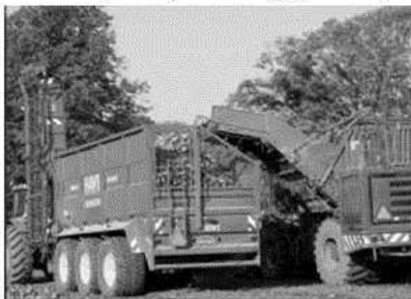
Рисунок 1.6 – Безостановочная уборка сахарной свеклы с использованием прицепа-перегрузчика RUW
