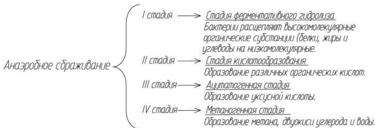
Рисунок 1.2 - Биохимические реакции процесса разложения биомассы
