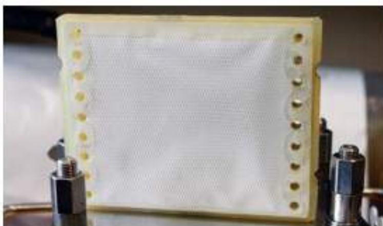
Рисунок 2.1 - Полимерная мембрана, запатентованная ИХХС РАН им. А.В. Топчиева
