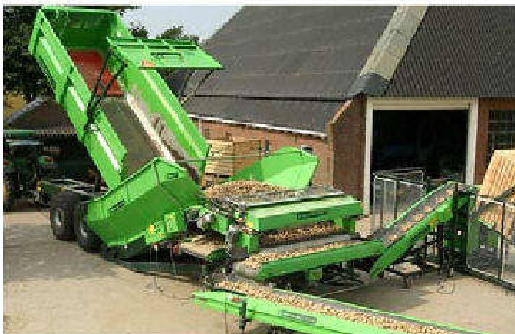
Рисунок 2.2 – Закладка картофеля в хранилище навального типа по прямоточной технологии «спеле-хранилище» с минимальной доработкой
