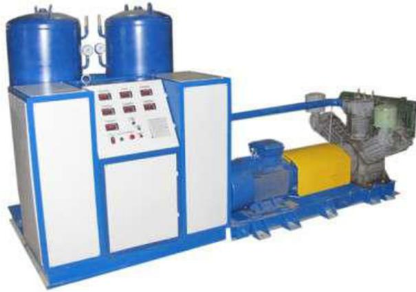
Рисунок 1.2 - Автоматизированный стенд для обкатки испытания компрессоров.
