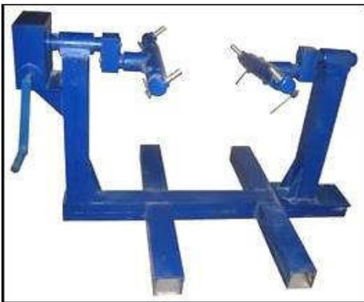
Рисунок 1.1 - Стенд М-401 (СТУ-300) для сборки-разборки КПП КАМАЗ и ЯМЗ-236, -238 (ручной)
