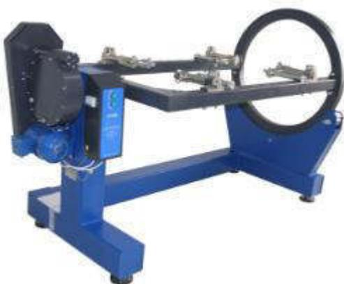
Рисунок 1.3 - Стенд разборки-сборки универсальный Р-776Е/Р-770Е для двигателей, КПП, задних мостов и др. агрегатов.
