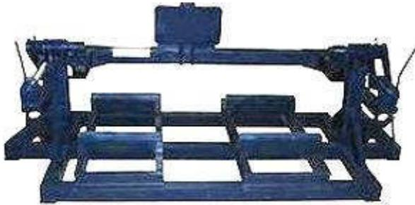
Рисунок 1.2 - Стенд для разборки-сборки КПП Д-160 М-409.
