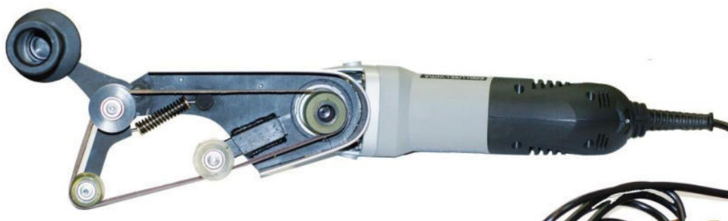
Рисунок 3.4 Машинка полировальная на базе углошлифовальной машины
