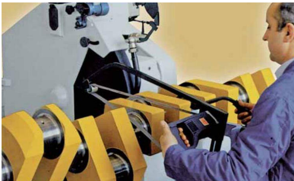
Рисунок 3.3 Полировальная машинка SFN/2B фирмы BERCO (Италия)
