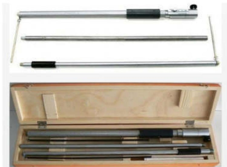
Рисунок 1.4 – Общий вид линейки ПСК-ЛГ предназначен для проверки схождения передних колес
