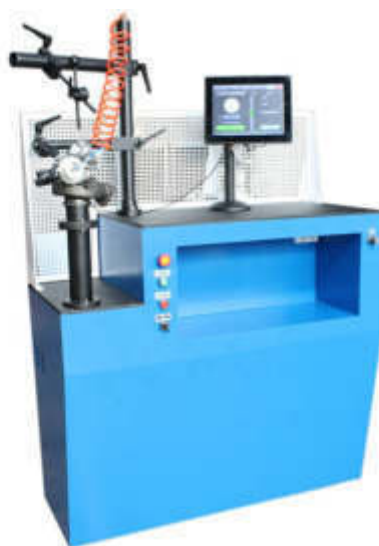
Рисунок 1.4 - Станок ГЕОМЕТ-2000 для испытания турбокомпрессоров
